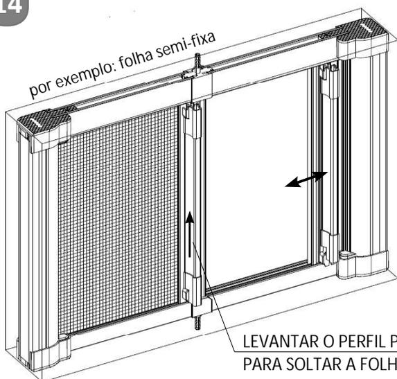
LEVANTAR O PERFIL PUXADOR PARA SOLTAR A FOLHA SEMI-FIXA
