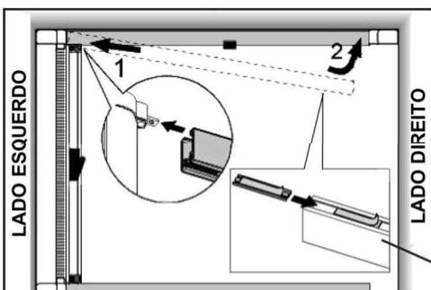
**9 b.** Posicionar a Guia Superior e preparar o Cobre-Tampa para a Caixa da Tela de Direita (DX)
