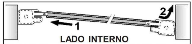
**9 c.** Após ter colocado também a Caixa da Tela no lado Direito (DX). Posicionar a Tela Mosquiteira de forma definitiva. Bloqueando-a por meio de Tampas a Expansão, com a chave allen.
