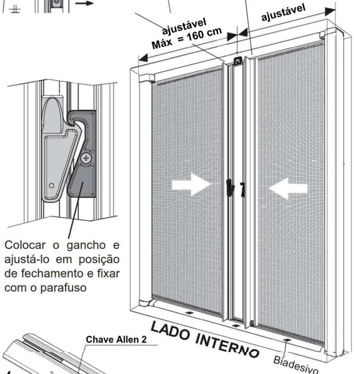
Colocar o gancho e ajustá-lo em posição de fechamento e fixar com o parafuso
