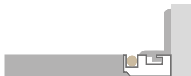
FIXAÇÃO NA ALVENARIA
